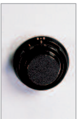
↳ Serrure à disques Sargent et Greenleaf A2P.B.UL Groupe 1, silencieuse, discrète, intâtable, anti-manipulations. 800 000 combinaisons. Les armoires STAR PROTECT équipées de cette serrure sont conformes à l'arrêté du 23 juillet 2010, classe de sécurité C (N°1300/SGDN/PSE/PSD).
