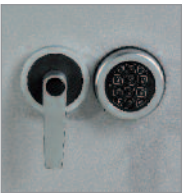
↳ Serrure de coffre-fort classe 2 VDS, 1 000 000 de combinaisons alphanumériques, intâtable, temporisée après la 3 e erreur. 1 code maître et un code utilisateur programmables. Condamnation automatique à la fermeture de l'armoire. Alimentation par pile avec système extérieur de secours.
