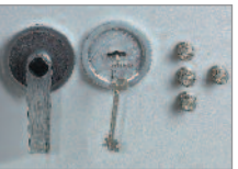
↳ Serrure de coffre-fort WITTKOPP réf. 2618 testée A2P niveau A (2 clés fournies), asservie à une serrure 4 tubes compteurs de 20 numéros totalisant 160 000 combinaisons.
